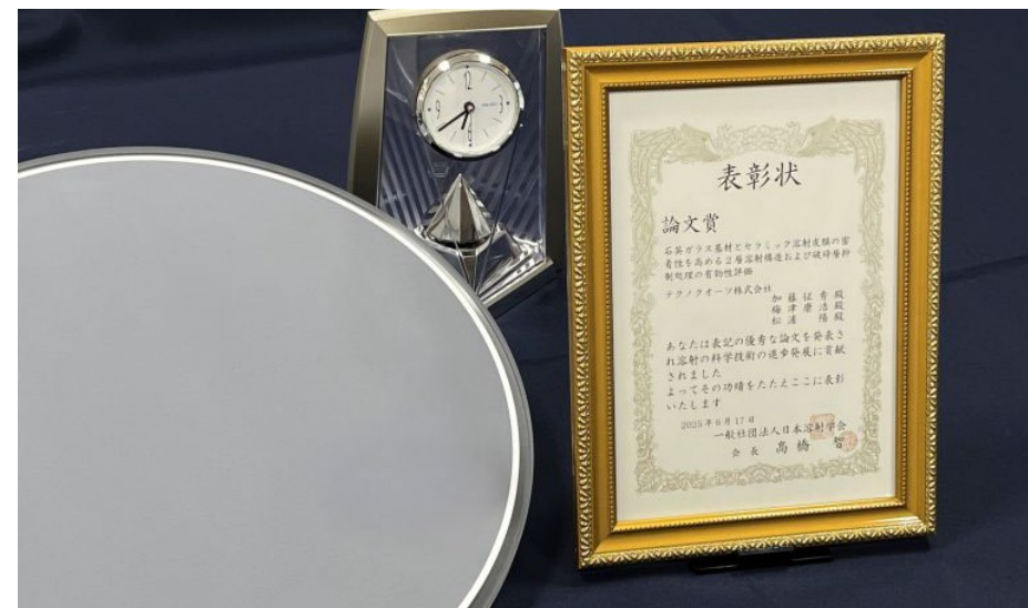
写真左側：セラミック溶射皮膜で被覆された石英ガラス部材
